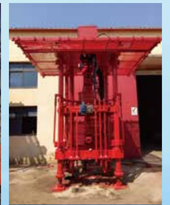
油水井带压作业装置
