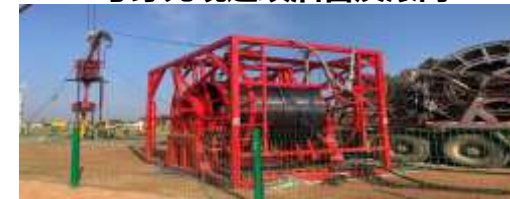
2寸穿光缆连续油管及滚筒
