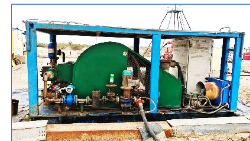
增压注水设备
